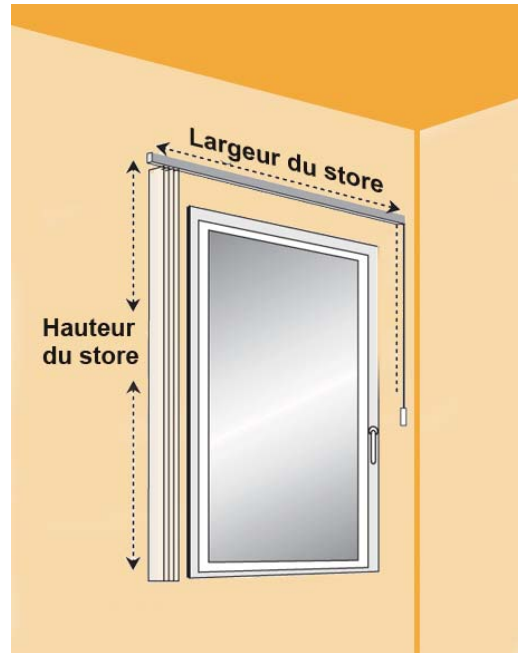
Pose en façade
