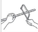
Recouper le guide inférieur à la largeur totale de l'ouverture.
