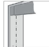
**6** Fixation des supports ou du profil de fixation : Tracer l'axe vertical entre le rail supérieur et le guide inférieur.
