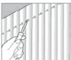
1 Contrôler que la tension des fils est homogène:
